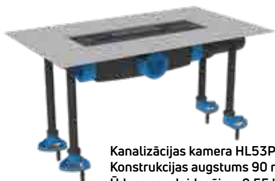
Kanalizācijas kamera HL53.0 Konstrukcijas augstums 90 mm Ūdens caurlaidspēja = 0,83 l/s
